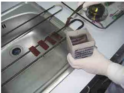
Рисунок 4.4. Удаление фильтровальной бумаги пинцетом в емкость с дезинфицирующим раствором.
