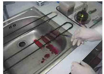
Рисунок 4.6. Удаление остатков воды, выполняемое после каждой процедуры промывки (стекла с мазками поочередно ставят пинцетом на ребро).
