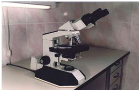
Рис. 18. Общий вид и устройство светового бинокулярного микроскопа
