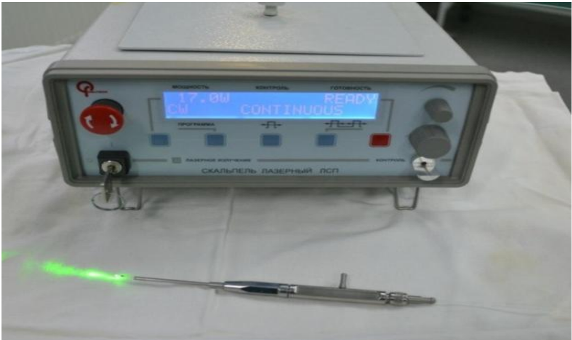
Рисунок 2.8 – Аппарат высокоэнергетического лазерного излучения ЛСП-30
